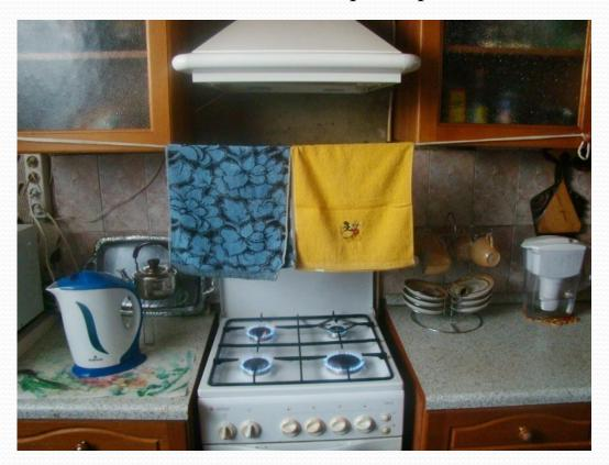
Грубейшее нарушение правил пожарной безопасности – нельзя сушить белье над газовой или электрической плитой.
